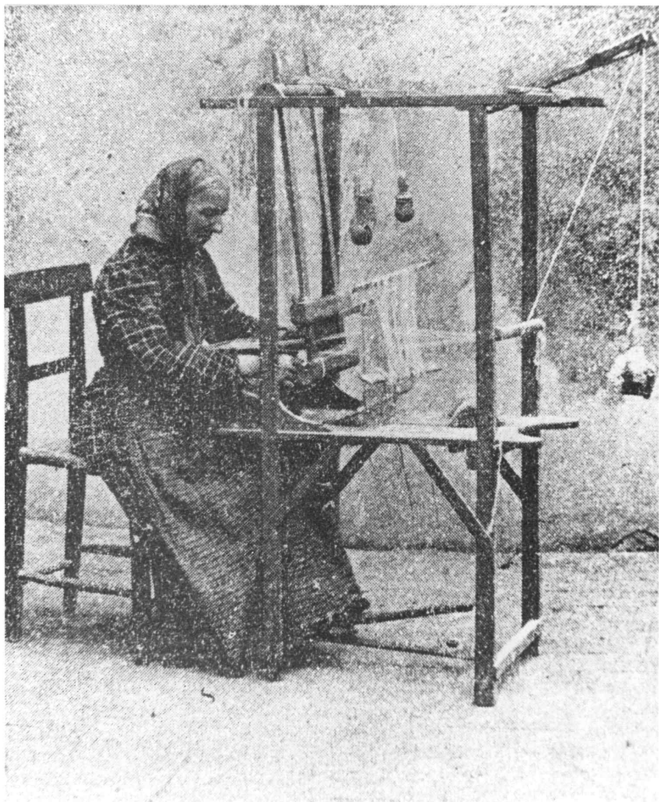
Vecchia tradizione artigiana di Fiesole: sopra telaio tipico fiesolano per la tessitura dei « bigherini » di paglia. Nella pag. precedente scalpellini negli anni '30.
